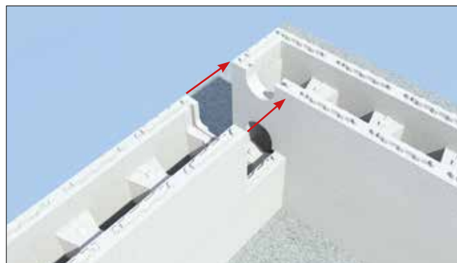
20 Assemblage des blocs d'angles suite
