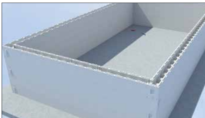
23 Murs de la piscine montés
