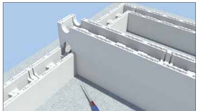
32 Montage du deuxième rang avec découpes des passages béton
